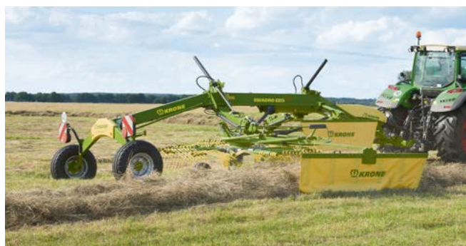
Валкователи с боковой укладкой TS и TS Twin Ширина захвата от 6,20 м до 8,20 м
