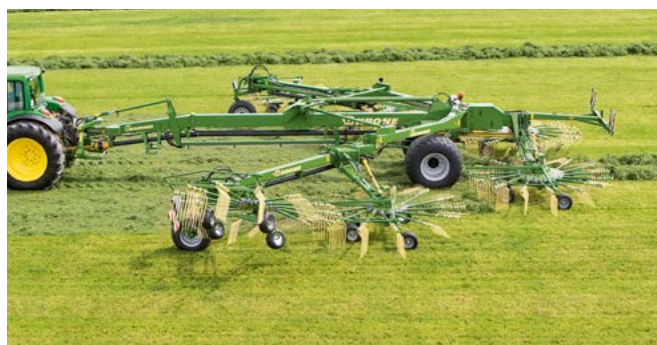
Валкователи с центральной укладкой Swadro 2000 Изменяемая ширина захвата от 11,00 м до 19,00 м
