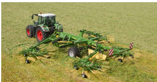
Валкователи с центральной укладкой Swadro 1400 и 1400 Plus Изменяемая ширина захвата от 11,00 м до 13,50 м
