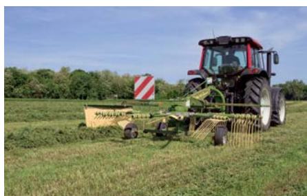
Однороторный валкователь Swadro, навесной Ширина захвата от 3,50 м до 4,60 м
