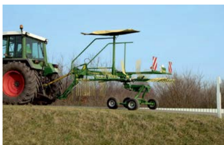
Однороторный валкователь Swadro, прицепной Ширина захвата от 3,80 м до 4,60 м
