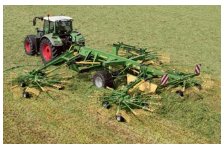
Четырехроторный валкователь с центральной укладкой валка Swadro 1400 и 1400 Plus - Изменяемая ширина захвата от 11,00 до 13,50 м
