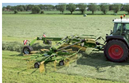
Двухроторный валкователь с центральной укладкой валка Swadro TC и TC Plus Изменяемая ширина захвата от 6,80 до 8,80 м
