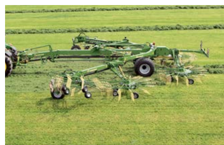
Шестироторный валкователь с центральной укладкой валка Swadro 2000 - Изменяемая ширина захвата от 11,00 до 19,00 м
