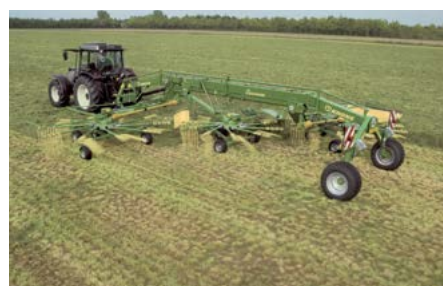
Двухроторный валкователь с укладкой валка на сторону Swadro 1010 Ширина захвата 9,70 м
