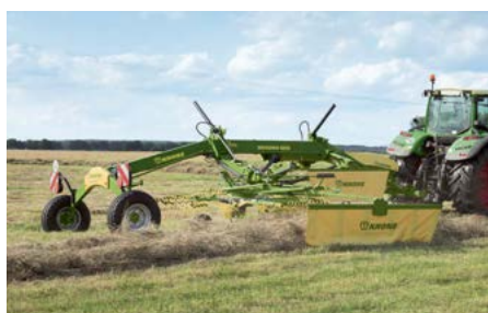
Двухроторный валкователь с укладкой валка на сторону Swadro TS и TS Twin Ширина захвата от 6,20 м до 8,20 м
